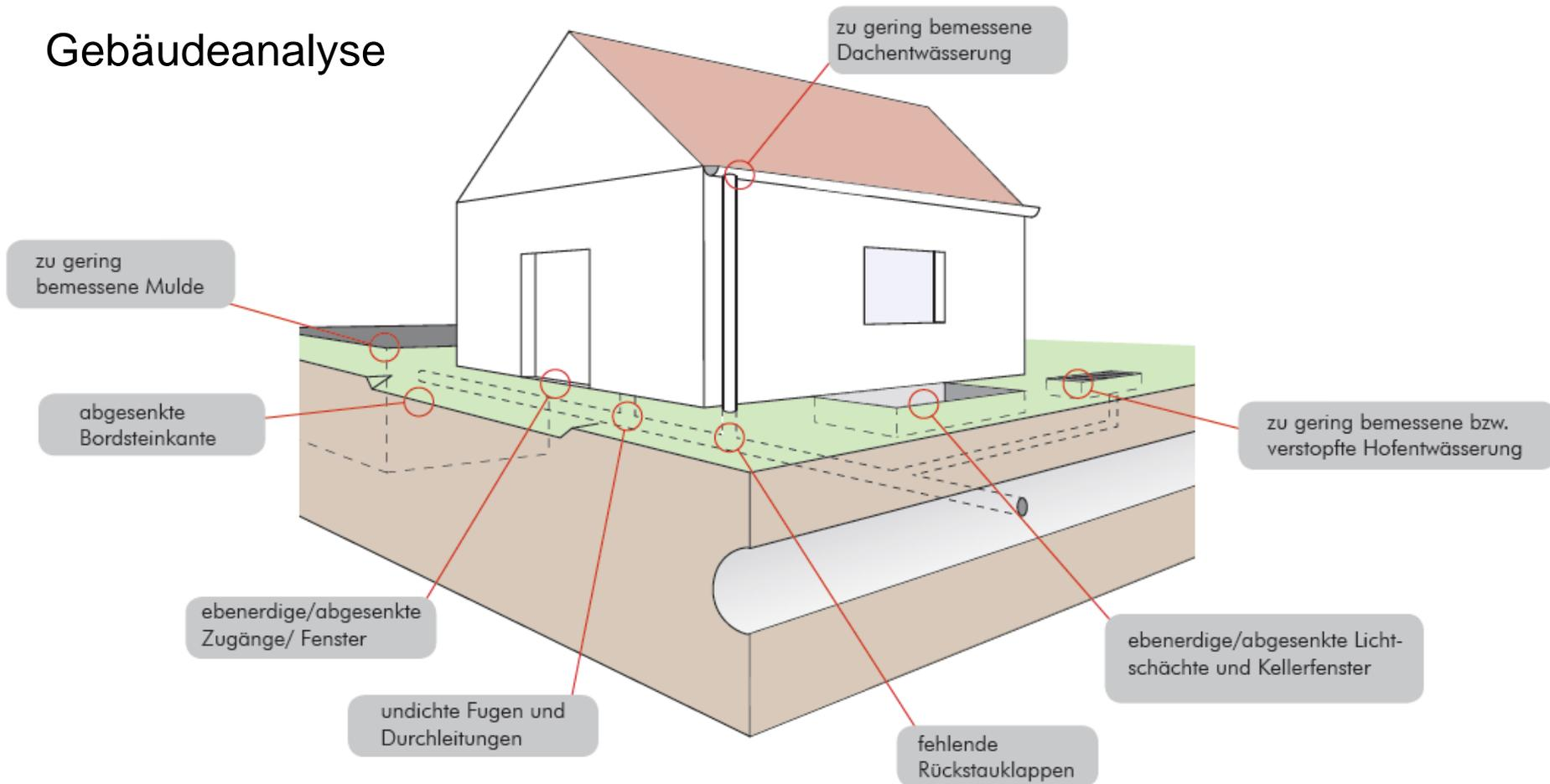
Abb. 14: Versagensmöglichkeiten in den Systemen der Grundstücksentwässerung
